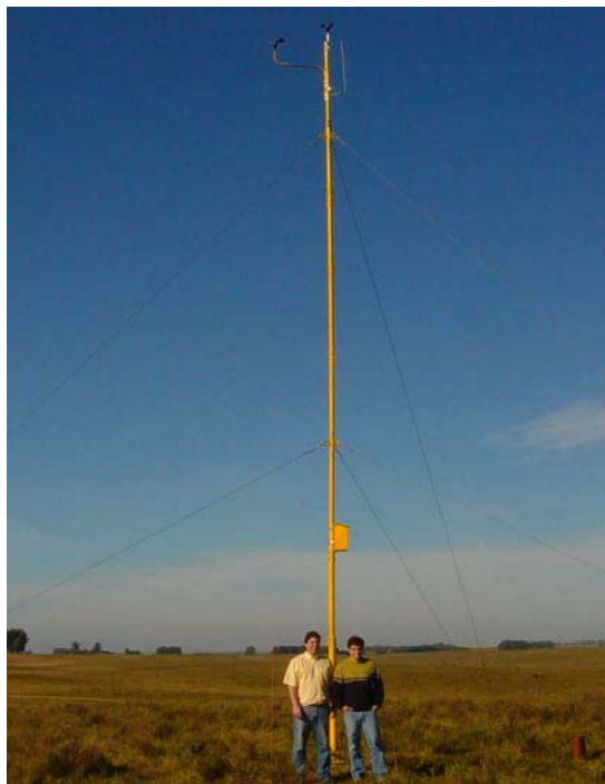
Figura 8. Torre anemométrica instalada
